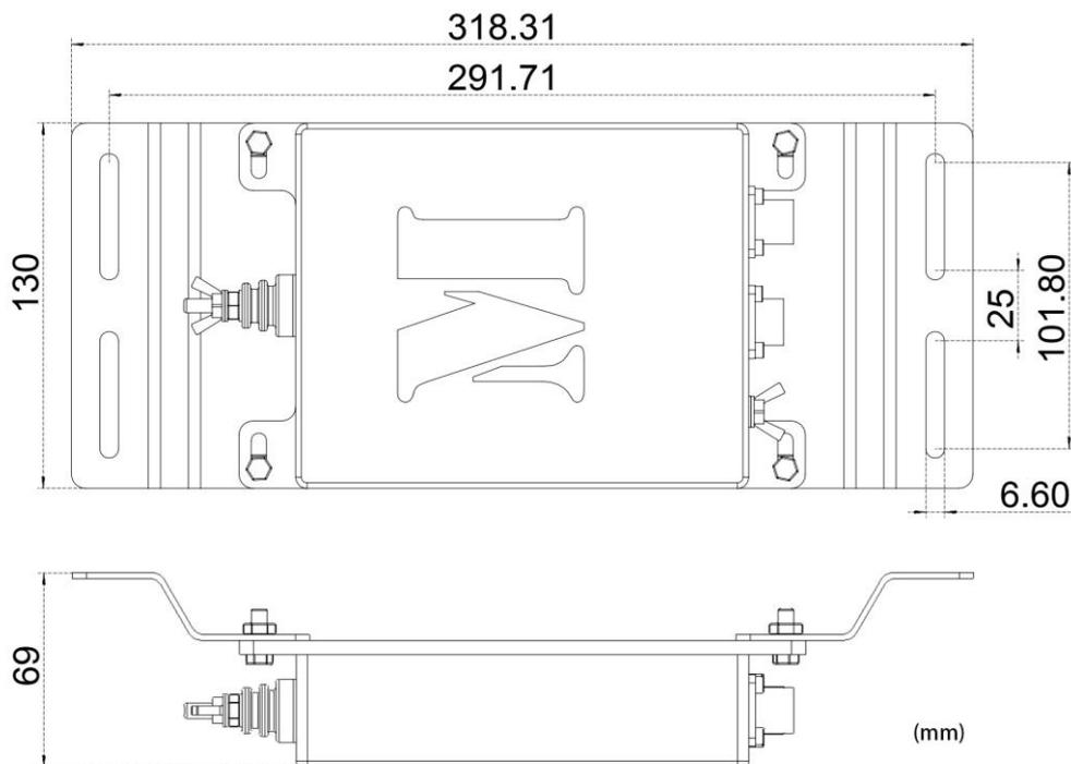
天调加装支架后的安装孔尺寸图
